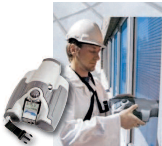
Obr. 2 – Meranie percenta naplnenia izolačného skla argónom.
