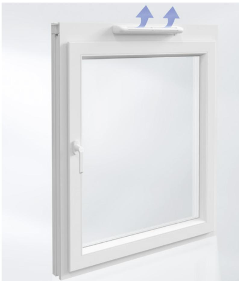
Schüco VentoPlus lüftet Räume exakt nach Bedarf, denn über einen mechanischen Feuchtesensor erfolgt die automatische, bedienerunabhängige Anpassung des Zuluftvolumenstroms. So ist eine sichere Entfeuchtung der Räume gewährleistet. Eine Stromzufuhr ist nicht erforderlich. Auch als Außenluftdurchlass in Verbindung mit Schachtlüftung oder Abluftanlagen ist Schüco VentoPlus ohne Probleme einsetzbar.
